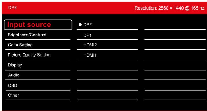
Prebacite ulaz signala na DP2, DP1, HDMI2, HDMI1 ili pustite monitor da automatski odabere izvor.
