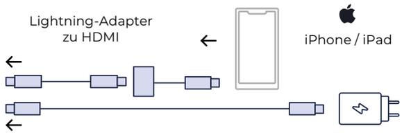
Achtung: Der Monitor muss an das Stromnetz angeschlossen sein
