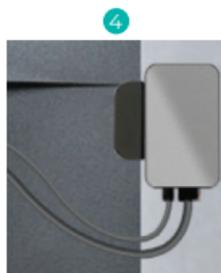
Befestigen Sie den Empfänger mit der beiliegenden Halterung an der Kante des Monitors.
